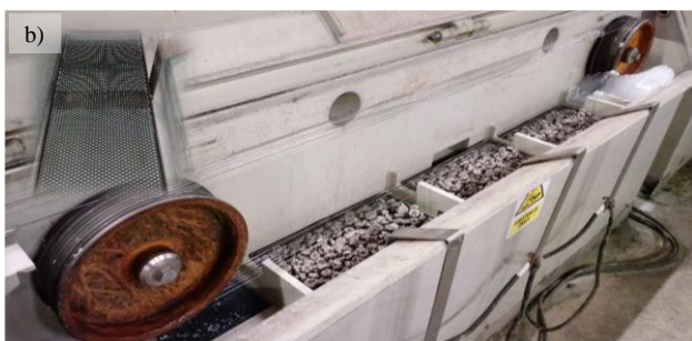
Obr. 2 Modifikovaná galvanizační vana s dodatečně instalovanými a) kartáči včetně držáků kartáčů, b) titanovými násypovými koši
