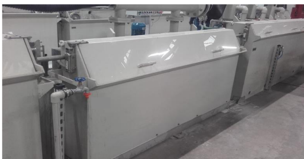
Obr. 1 Průběžná procesní vana pro nanášení ochranných povlaků na povrch drátu
